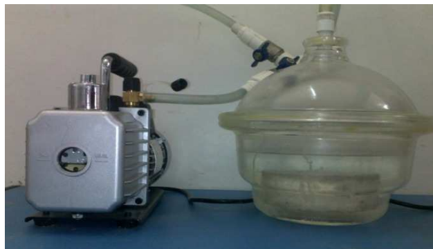
Figure III.4, Saturation des échantillons
