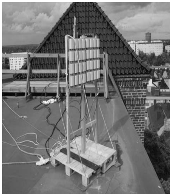
d- Réseau de capteurs plan pour les futures réseaux GSM Royal Institute of Technology, Stockholm.
