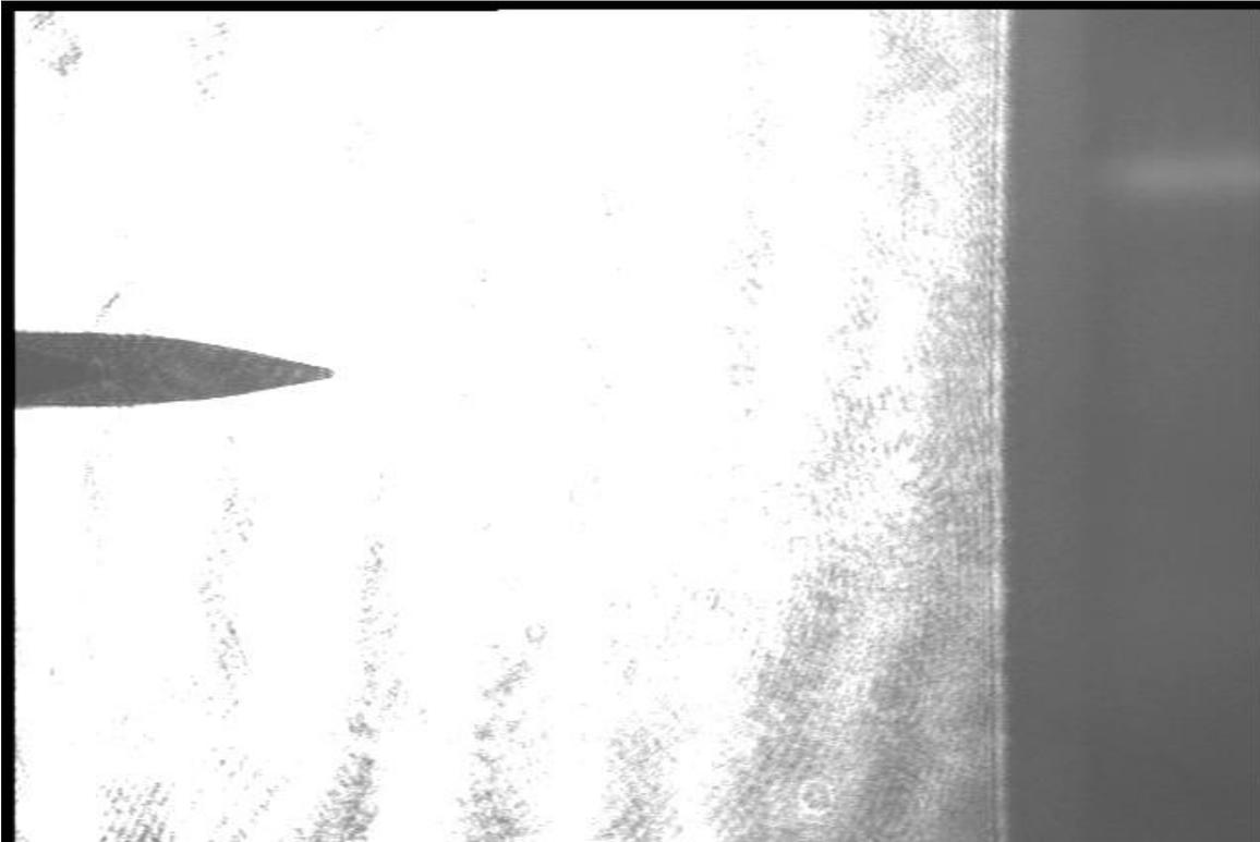
**Photo n°14 : réglage du plan image de la pointe en lumière spatialement incohérente (Laboratoire d'optique -Université de Tlemcen).**
