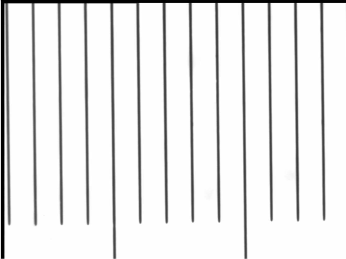
**Photo n °12 : image de la mire. Distance entre deux traits est de 100  $\mu\text{m}$  (laboratoire d'optique -Université de Tlemcen).**
