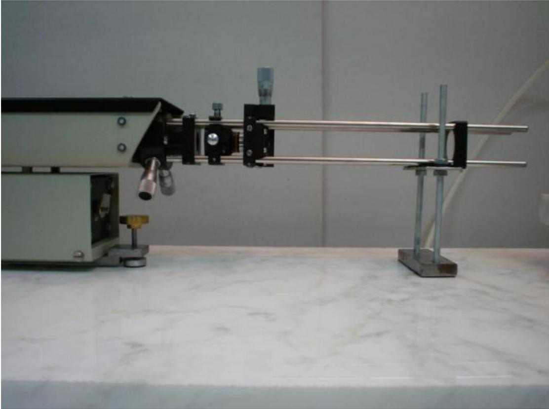
**Photo n°2 : vue de la source laser He-Ne 0.6328  $\mu\text{m}$  (objectif et trou source)
