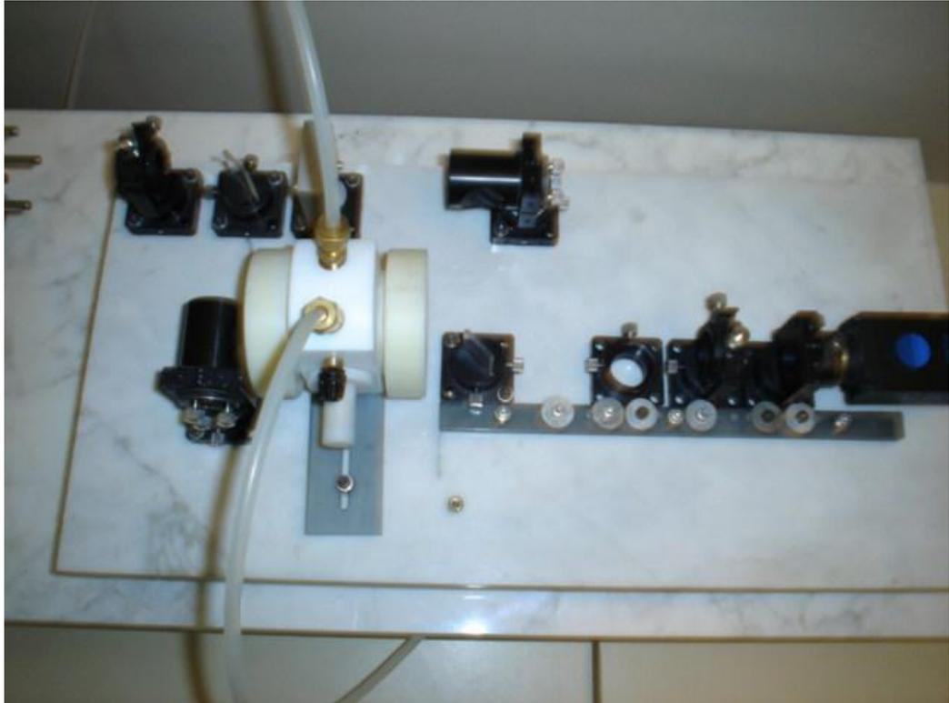
**Photo n ° 3 : Vue de dessus de l'interféromètre Mach Zehnder (laboratoire d'optique-Université de Tlemcen).**
