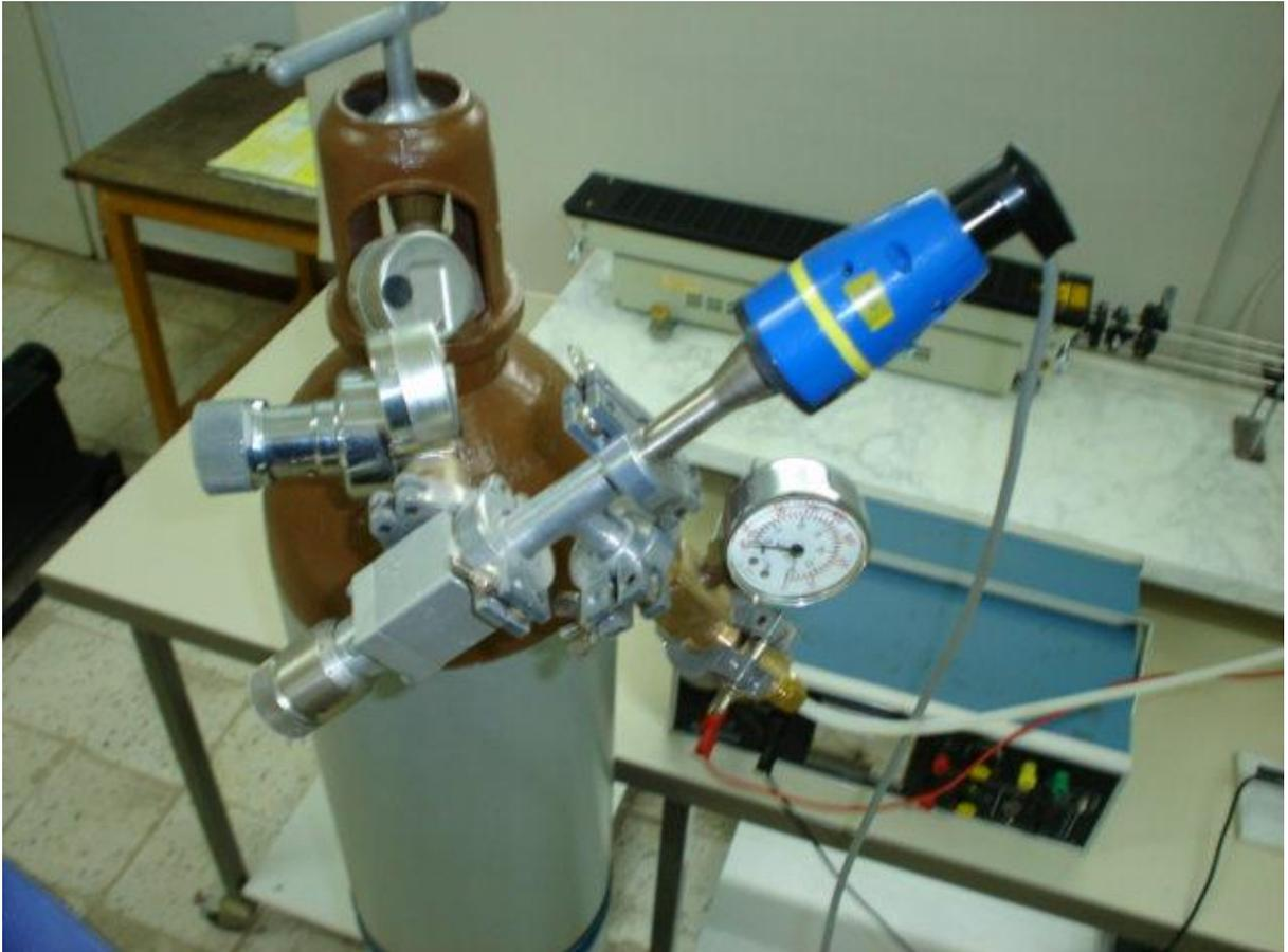
**Photo n °7 : vue de la vanne et de la jauge pirani qui peut aller jusqu'à 10-2 mb (laboratoire d'optique - Université de Tlemcen).**
