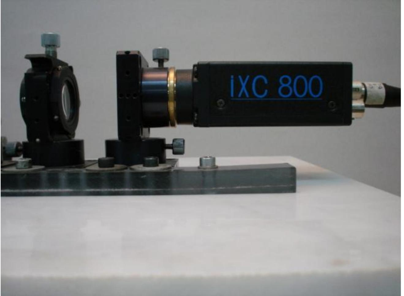
**Photo n ° 4 : Caméra CCD avec lentille d'imagerie
