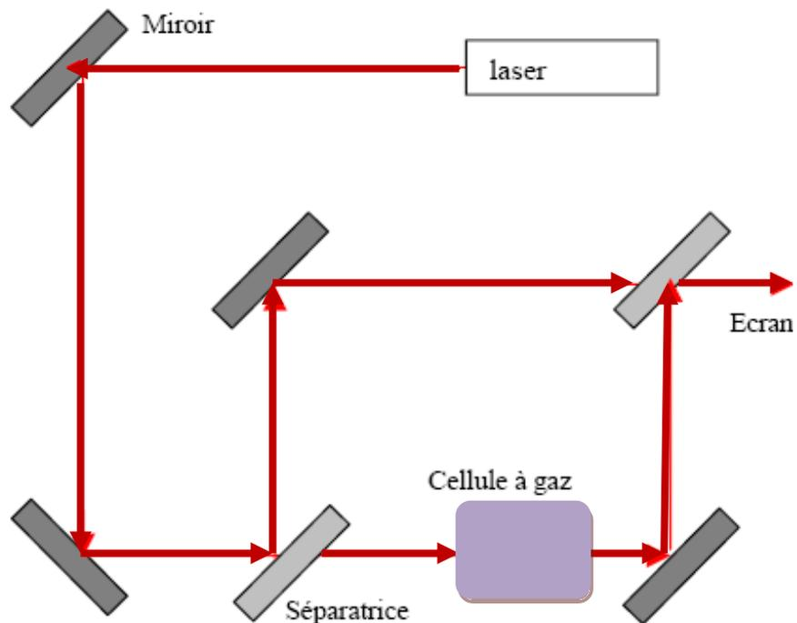
**Figure II.1 Dispositif expérimental du Mach Zehnder**
