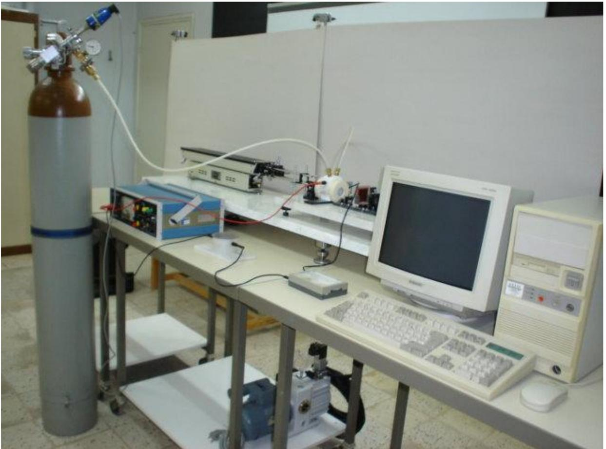
**Photo n°1 : vue d'ensemble du dispositif interférométrique Mach-Zehnder avec le groupe pompe à vide, la bouteille à gaz et le micro-ordinateur (laboratoire d'optique - Université de Tlemcen).**
