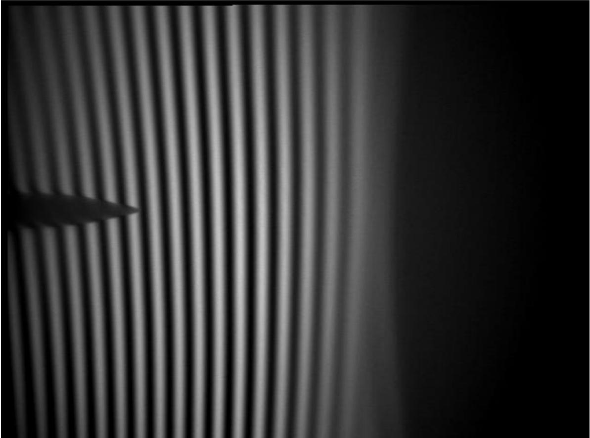
**Photo n° 13 : réglage du plan d'interférence sur la pointe en lumière spatialement incohérente
