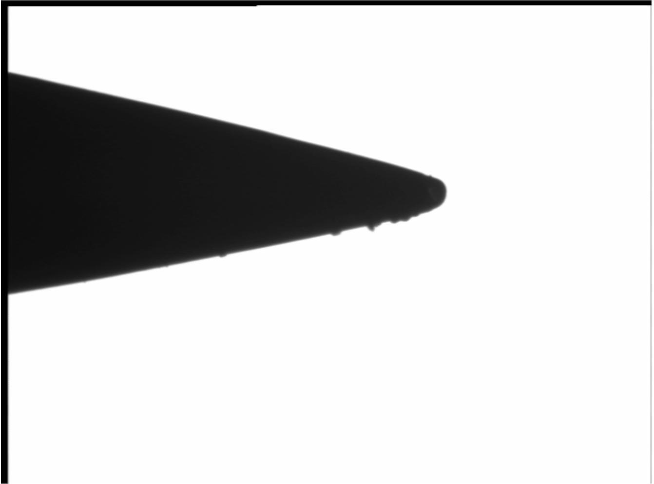
**Photo n°11 : image de la pointe en acier inox de rayon de courbure 100  $\mu\text{m}$
