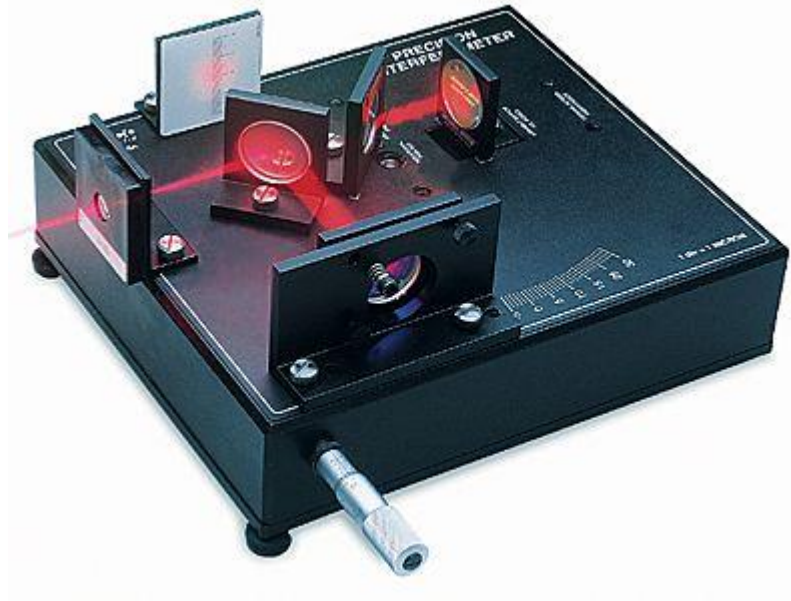
(Figure. 1-22) : Interféromètre de Twyman-Green [2]
