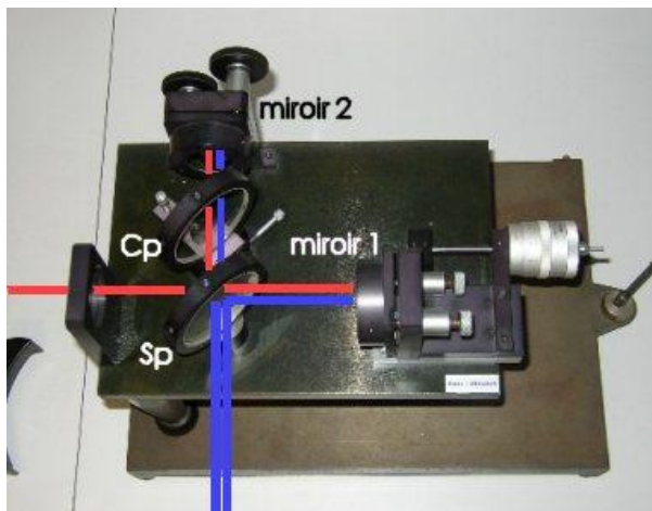
(Figure-1-6)-Trajets des rayons dans l'interféromètre
