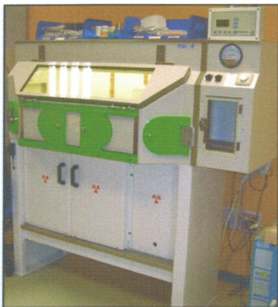
Figure 31 Enceinte blindée de moyenne énergie ( $^{99m}\text{Tc}$ )
