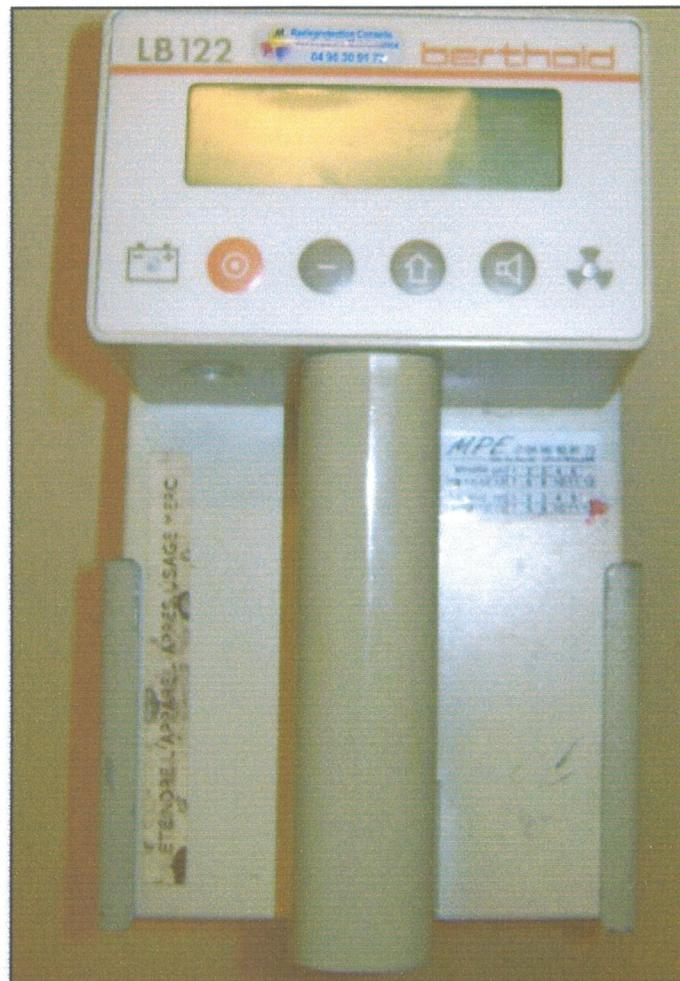
Figure 37. Contaminamètre LB122®(BERTHOLD) (Sari Ali, 2013)
