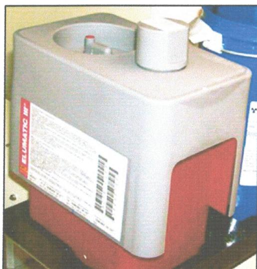
Figure 7. Générateur  $^{99}\text{Mo}/^{99\text{m}}\text{Tc}$  (Elumatic III Cis Bio)
