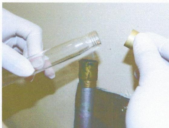
*Figure 45 : Flambage de l'orifice du tube*
