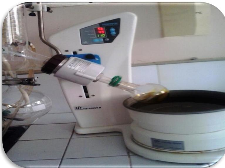
**Photo 06 :** Evaporateur rotatif de type *HAHNSHIN HS-2005 V-N*
