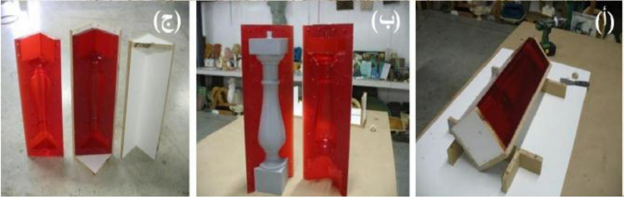
شكل (27) طريقة عمل القوالب المرنة
