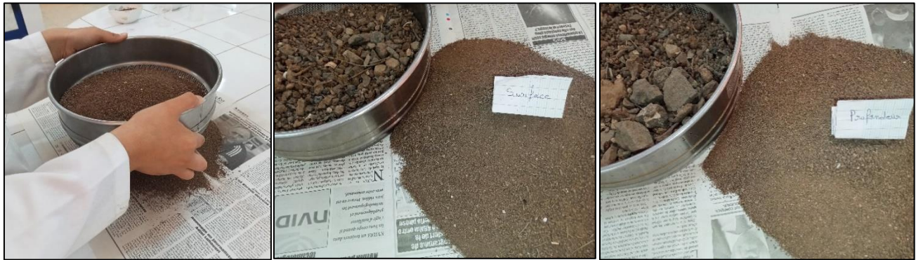
Figure 25 : Tamisage d'un Echantillon de sol à l'aide d'un tamis à maills de 2mm (KABLI, 2024).
