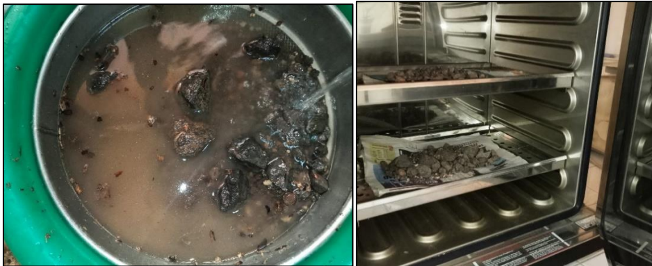
Figure 26 : Eléments grossiers récupérés et séchés dans une étuve (KABLI, 2024).
