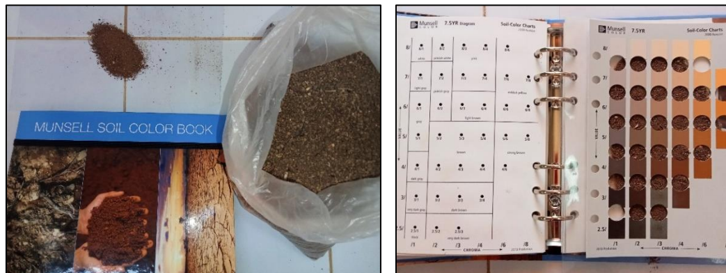
Figure 28 : Identification de la couleur du sol à l'aide du Munsell Soil Color Book (KABLI, 2024).
