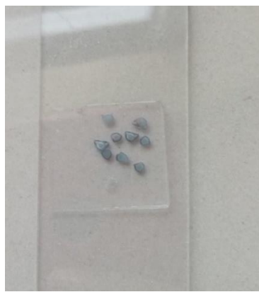
Placement entre lame et lamelle
