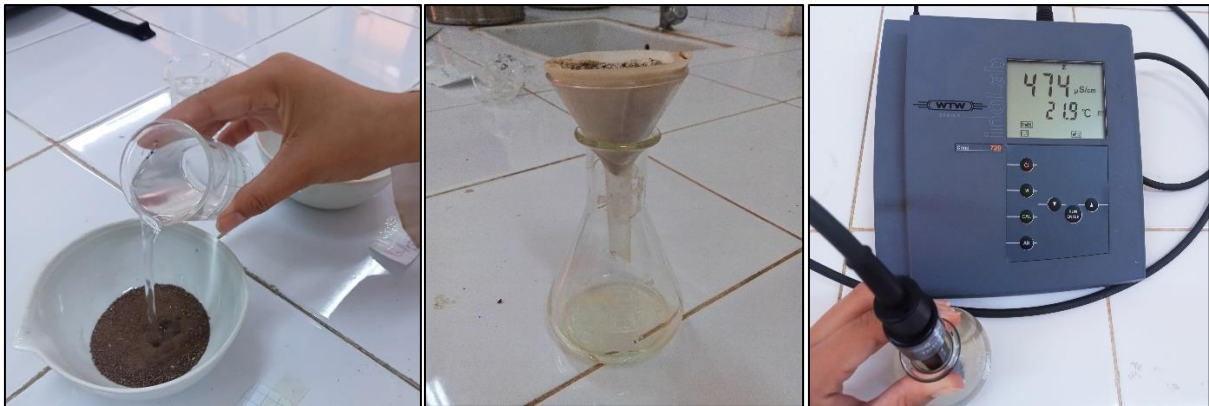
Figure 34 : Mesure de la conductivité électrique (KABLI, 2024).
