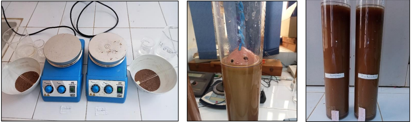
Figure 27 : Différentes étapes de l'analyse granulométrique (KABLI, 2024).
