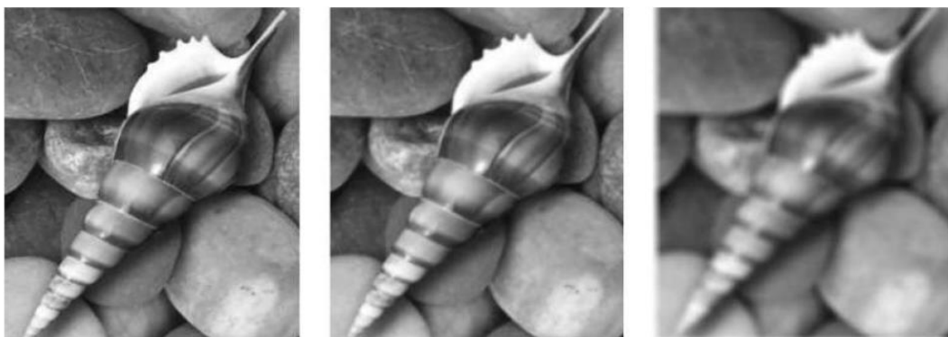
Figure 2 : Application du filtre moyenneur, (a) : image d'origine, (b) : filtre 3×3, (c) : filtre 9×9
