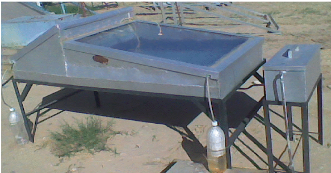
Figure N°2 : Un distillateur solaire couplé à un condenseur
