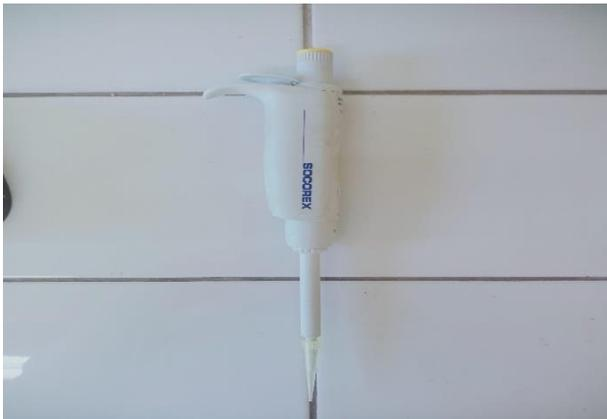
Figure 16: Micro pipette (originale)
