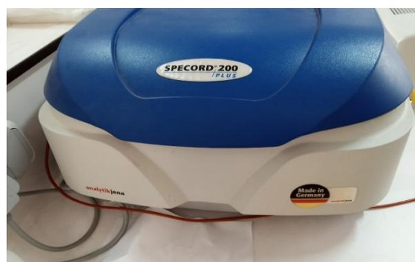
Figure II- 17: Spectrophotomètre UV-Visible (Specord 200 Plus) + Porte échantillon
