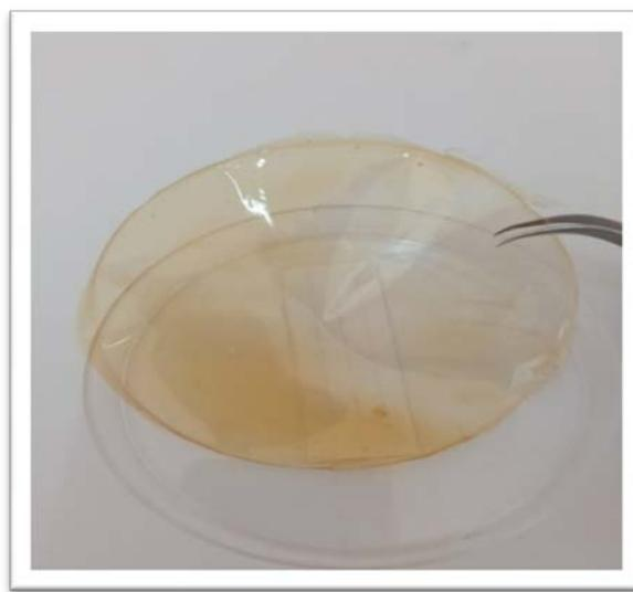
**Figure III- 18** : film CT/HEC à 2% d'acide acétique **Figure III-19** : film CT/HEC/GLU à 2% d'acide acétique
