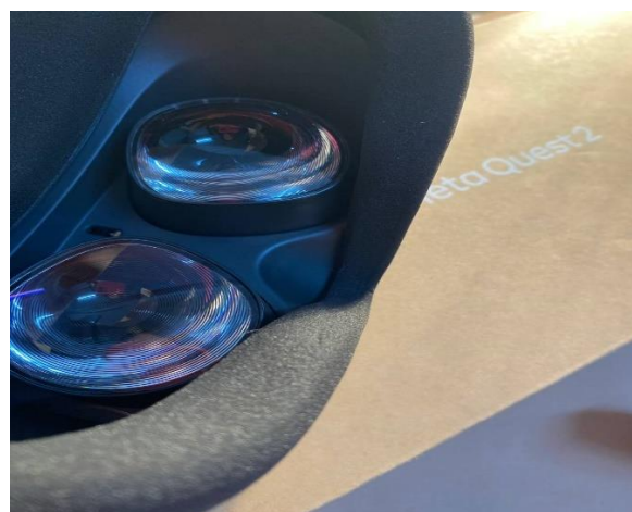
Figure 75: Lentilles en 3 positions pour une image nette.
