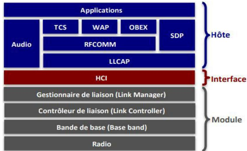
**Figure 2.2: Les piles de protocoles Bluetooth**
