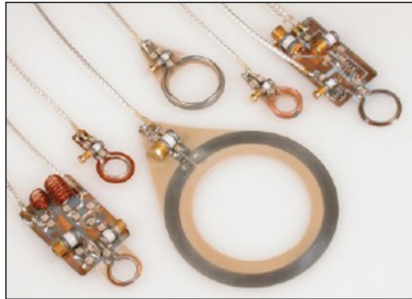
Figure I.25 : Différents types d'antennes de surface.
