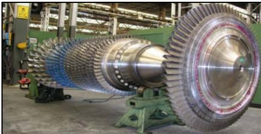
Figure [I.2]: Vue d'ensemble rotor de turbine HP à compresseur (MS5002b)[13].
