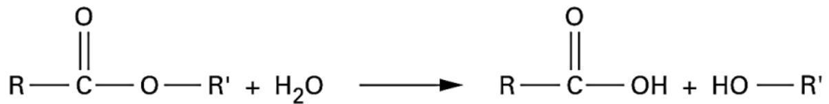
**Figure I.12** : Mécanisme général d'hydrolyse des polyesters [47]
