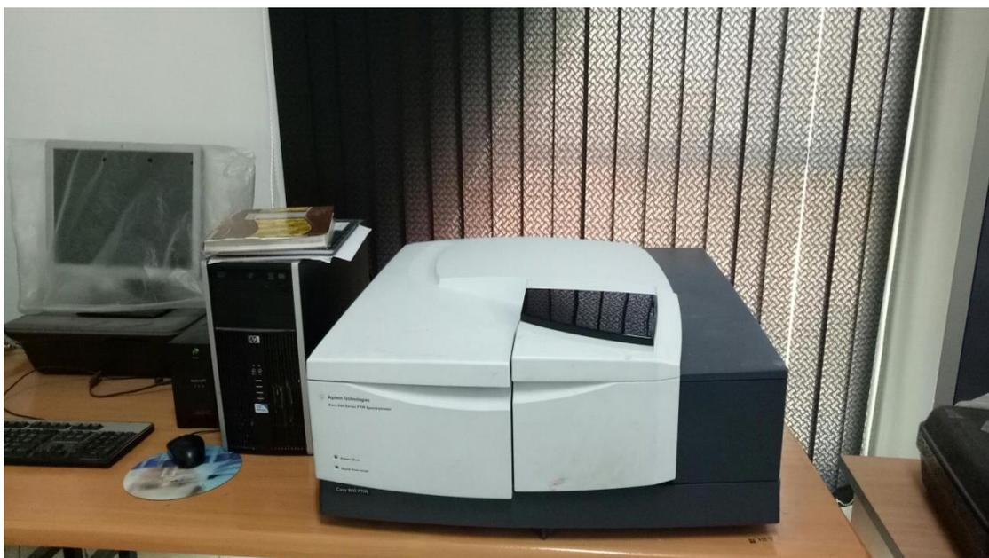
**Figure II.7 :** Spectromètre à TF (De type cary 640 FTIR – Agilent technologies)
