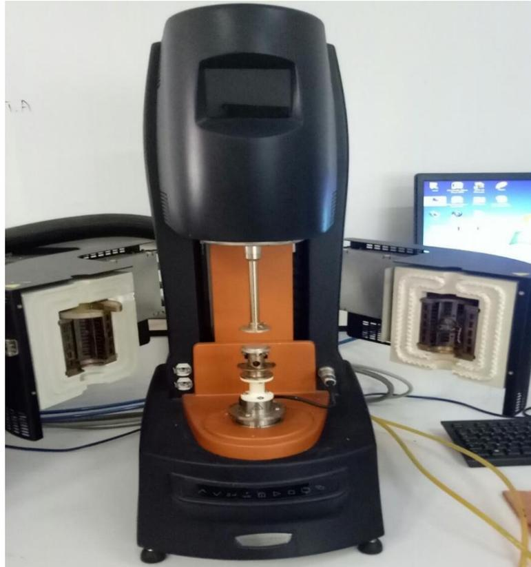
**Figure II.13:** Rhéomètre (Discovery Hybrid HR-2)
