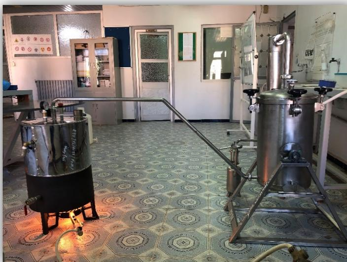
**Figure 15: Appareil semi-industriel d'entraînement à la vapeur d'eau.**
