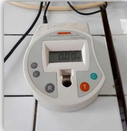
**Figure 20: Mesure de la densité optique à l'aide du colorimètre.**
