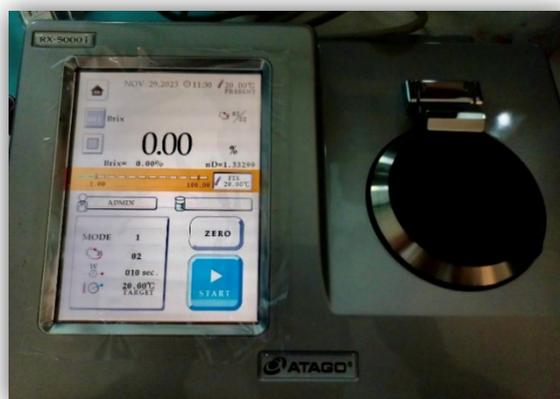
**Figure 17: Réfractomètre numérique modèle RX-5000i-plus ATAGO.**
