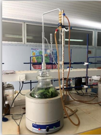
**Figure 16 : Appareil d'hydrodistillation « dispositif de Clevenger ».**
