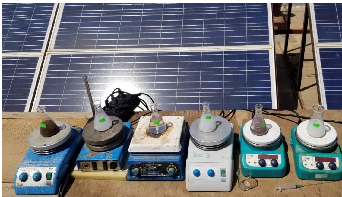
Figure II.14 Tests de dégradation photocatalytique du paracétamol sous irradiation solaire naturelle sur TiO 2 mésoporeux pur, dopé et codopé
