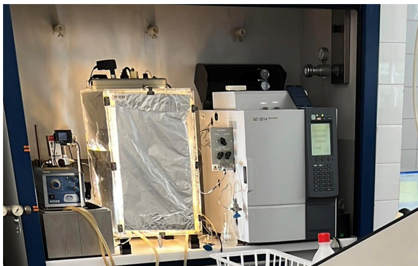
Figure II.16 Montage du test de production d'hydrogène par dissociation photocatalytique sous irradiation de la lumière visible (Université Autonome de Barcelone)
