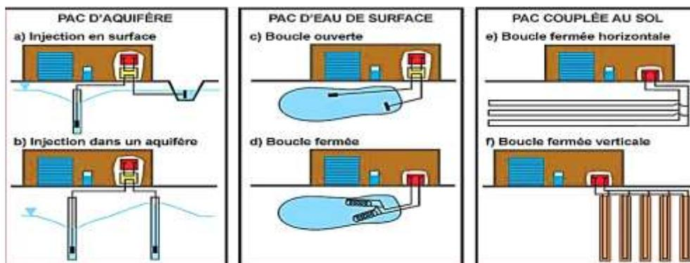
Figure (I.17) : Systèmes (GSHP) en boucle ouverte (a, b, c) et fermée (d, e, f)[61].
