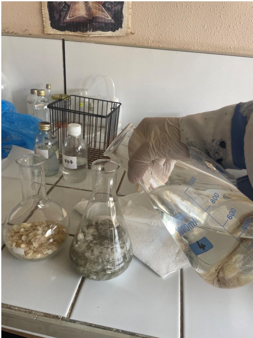
Figure 15 : l'opération de trempage de NaOH pendant 2h (Photo originale 2024)
