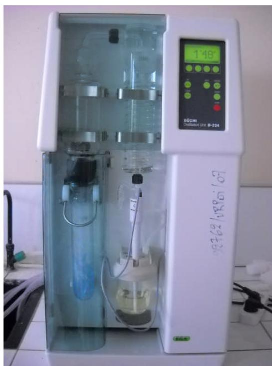
**Figure 10 : Distillateur de Kjeldahl**
