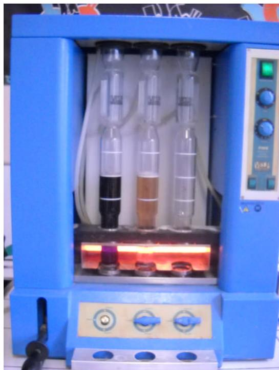
Figure 12 : Extracteur de fibres (fibre-test)
