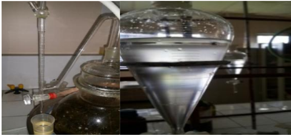
Figure 7: Procédé d'obtention de l'hydrolat
