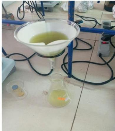
*Figure 10: filtration d'échantillon après macération à froid*
