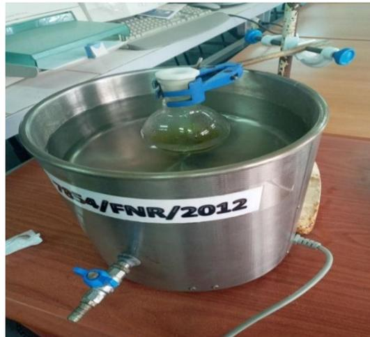
*Figure 12: extraction par l'ultrason*
