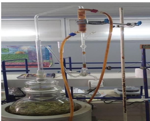
**Figure 11.** Photographie de montage d'hydrodistillation (photo originale)
