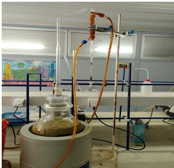
Figure.I.3 : Montage de l'hydrodistillation type Clevenger
