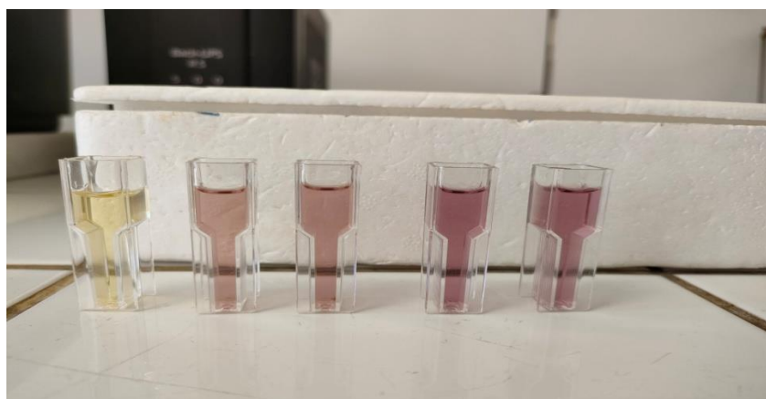
Figure III.4: Variation de l'intensité de la couleur du DPPH en fonction de la concentration
