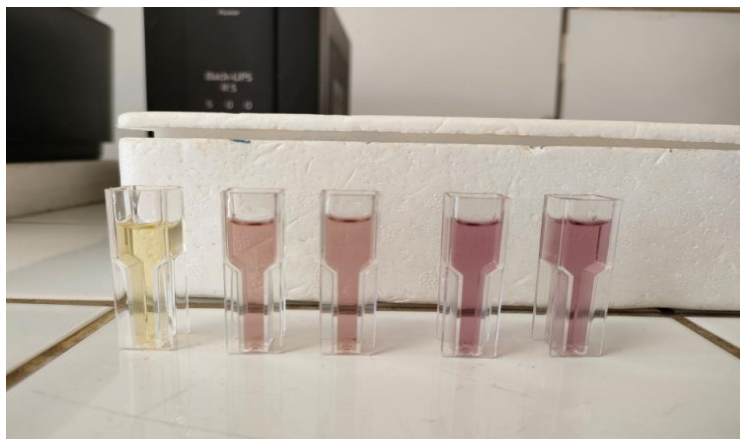
Figure II.6 : Changement de couleur par le test DPPH
