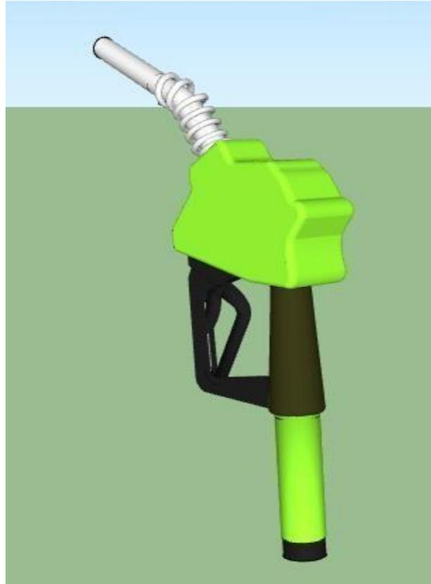
Figure 17 : modélisation pistolet à carburant
