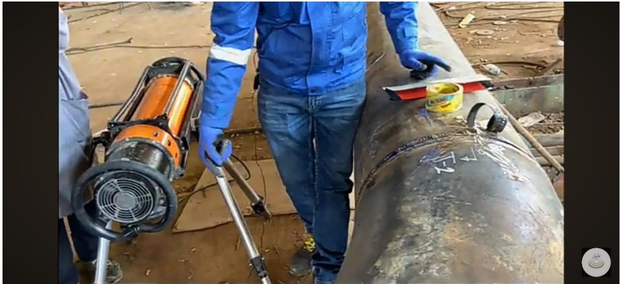
Figure IV.13 : Générateur de rayons x
