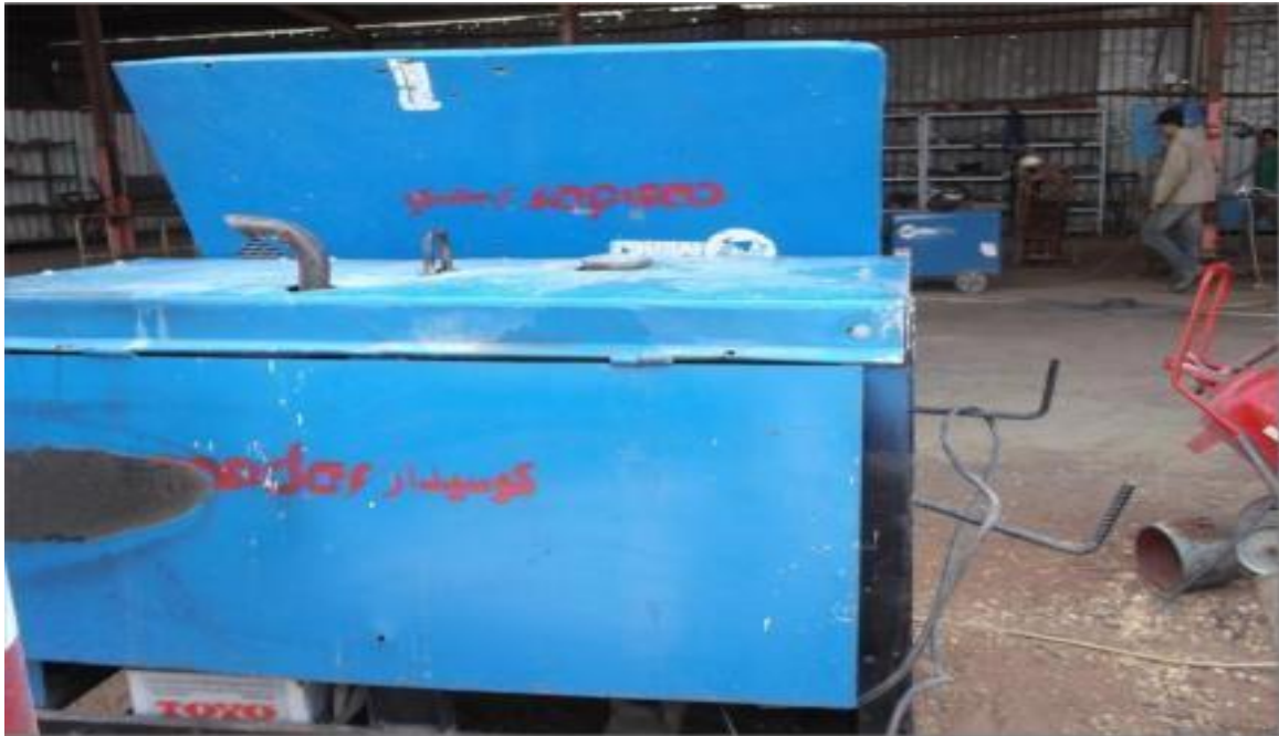
Figure IV.3 : Poste de soudure à l'arc électrique
