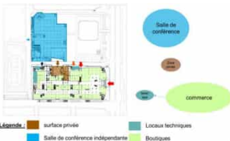
Figure 89 : Plan du rez de chaussée du complexe Sétif park mall / Source : auteur
