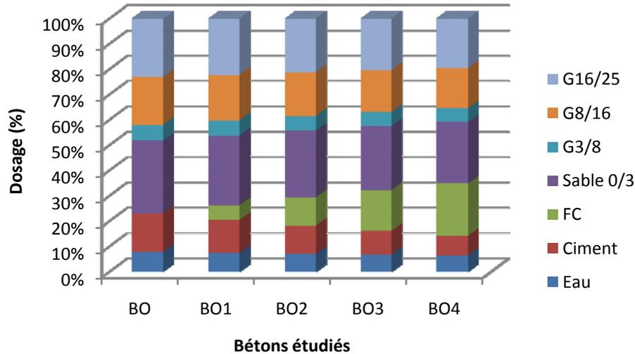
Figure 3.3 Composition des bétons
