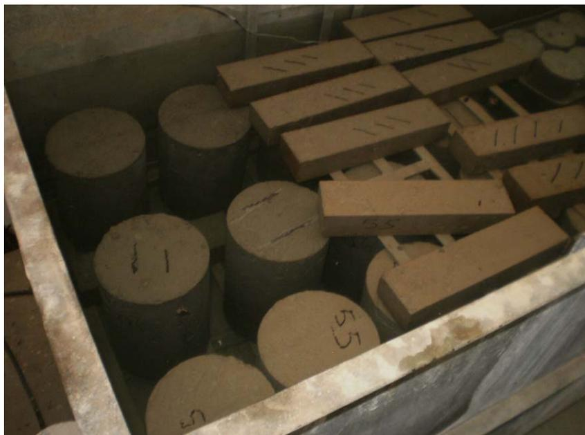
Figure 2. 4 Cure des éprouvettes (immersion totale dans l'eau).
