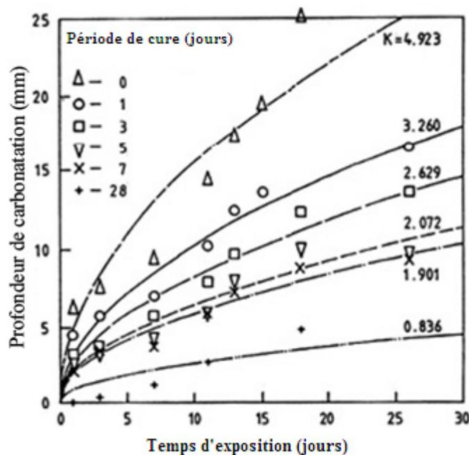
Figure 1. 24 Profondeur de carbonatation en fonction du temps pour un béton ayant subi une cure pendant 0, 1, 3, 5, 7 et 28 jours [Fattuhi, 1988]
