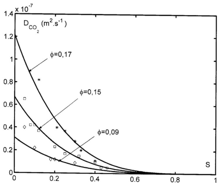
Figure 1. 37 Calage de la loi d'évolution du coefficient de diffusion au  $CO_2$  en fonction de la porosité  $\phi$  et du taux de saturation  $S$  [mesures sur mortiers tirées de Papadakis et col, 1991b]
