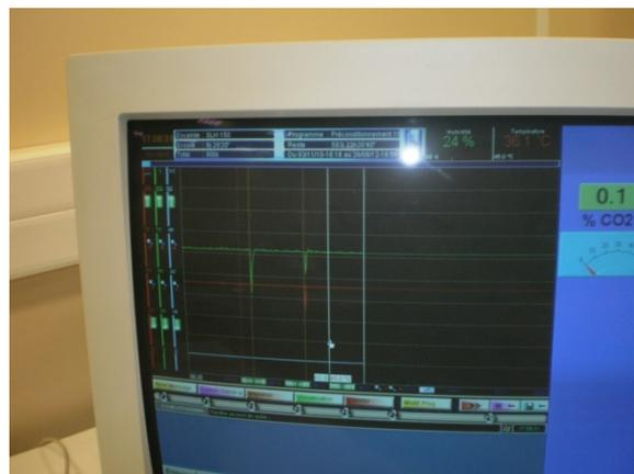
Figure 2. 8 Ecran de contrôle de la température et du taux d'humidité relative à l'intérieur de l'enceinte
