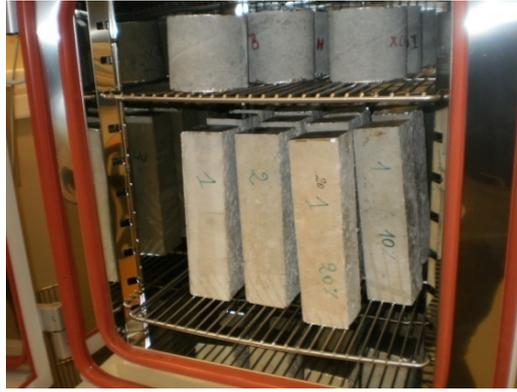
Figure 2. 10 Enceinte climatique assurant l'homogénéisation.
