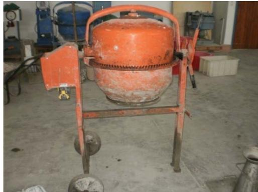
Figure 2. 1 Malaxeur d'une capacité de 125 litres
