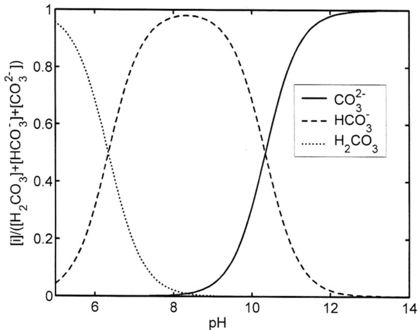
Figure 1. 2 Concentration du système des carbonates ( $H_2CO_3$ ,  $HCO_3^-$  et  $CO_3^{2-}$ ) en fonction du pH (à  $20^\circ C$  et à l'équilibre) (Thiery, 2005)
