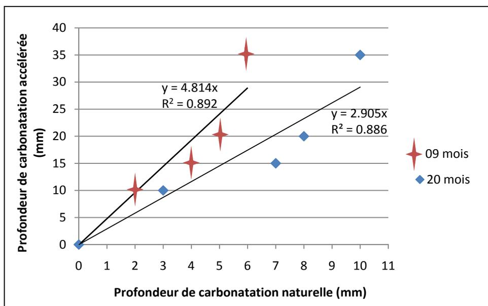
Figure 3.18 Profondeur de carbonatation accélérée et naturelle.
