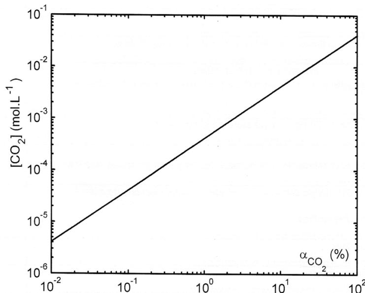
Figure 1. 1 Concentration en CO<sub>2</sub> dans la phase gazeuse en fonction de la fraction volumique α<sub>CO<sub>2</sub></sub> (à 20° C et sous une pression atmosphérique de 105 Pa) [Thiery, 2005]
