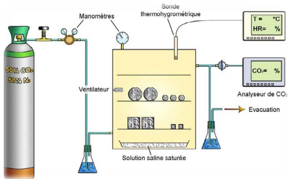
Figure 1. 34 Schéma d'une station de carbonatation accélérée [Olivier et col. 2007].
