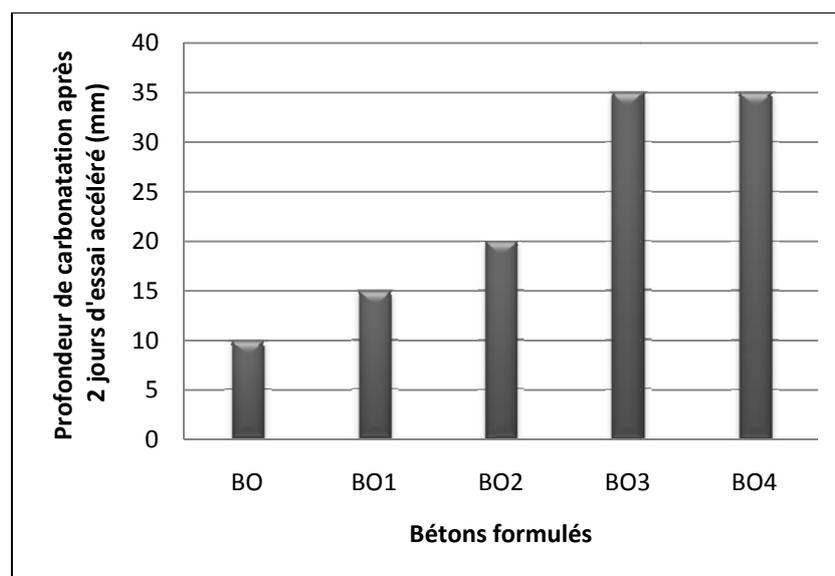
Figure 3. 12 Profondeurs carbonatées après 2 jours d'essai accéléré
