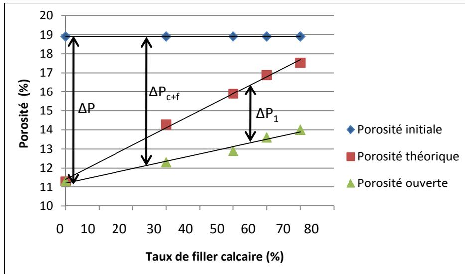
Figure 3.4 Variation théorique de la porosité  $P$ , des bétons durcis en fonction du taux de substitution du ciment par le filler calcaire (matériau inerte).
