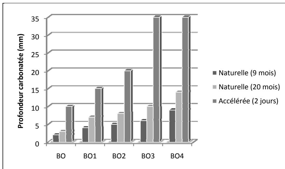
Figure 3.16 Profondeurs de carbonatation naturelle et accélérée.
