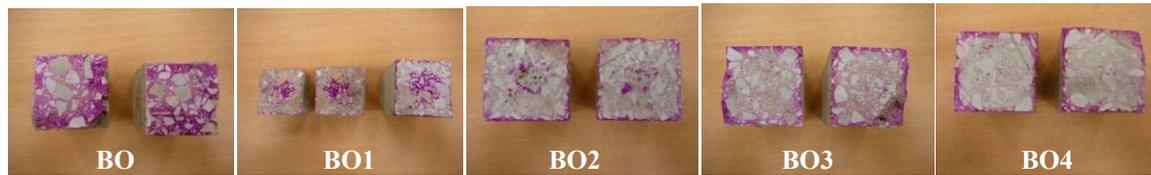
Figure 3. 11 Carbonatation accélérée à 2 jours sur les bétons BO, BO1, BO2, BO3 et BO4.
