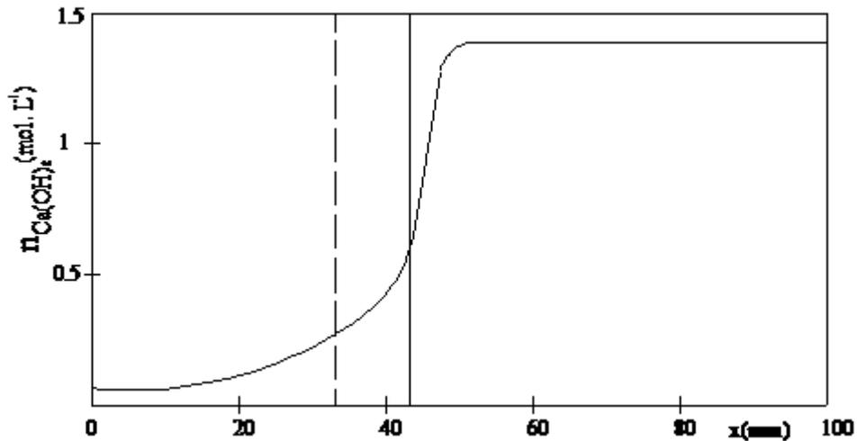
Figure 1. 36 Forme d'un front de carbonatation [Thiery, 2005]
