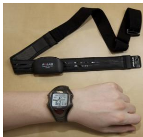
Figure 29 : Photo d'un cardiofréquencemètre montrant la ceinture thoracique et la montre.
