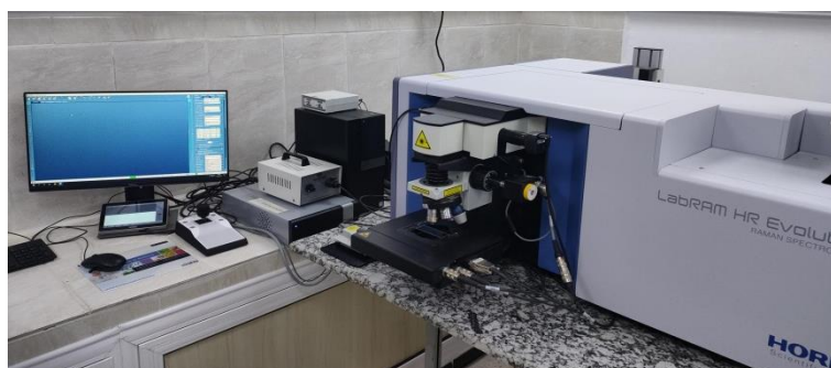
Figure 06 : Spectromètre RAMAN « HORIBA »
