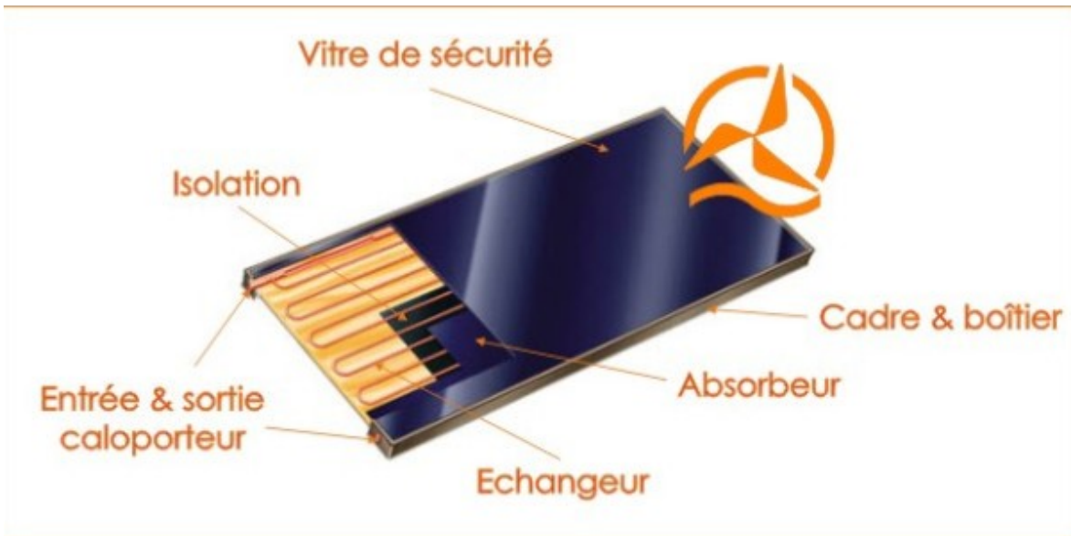
Figure I-18: capteur solaire thermique plan [32]
