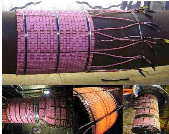
**Figure II.14:** Équipement de post chauffage. [22]
