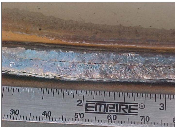
**Figure II.17:** Fissuration à chaud longitudinale. [25]
