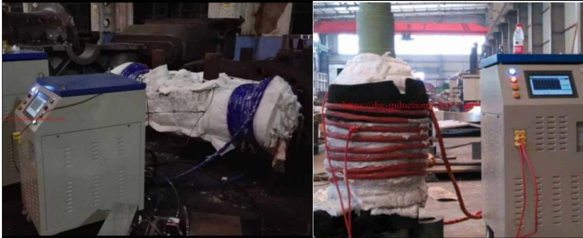
**Figure II.10:** Machine d'alimentation de la couverture chauffante. [15]
