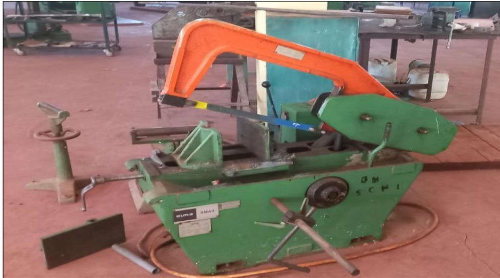
**Figure III.2 :** Scie mécanique OLMO SMA3.
