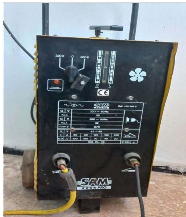
**Figure III.3:** Poste de soudure par électrode enrobée SAM PRO PS 250S.
