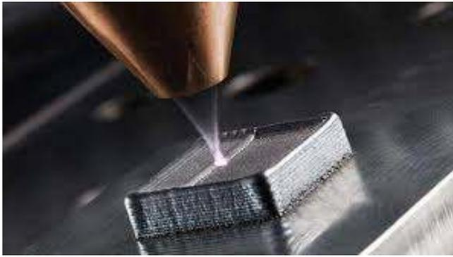
Figure 1.8: l'impression 3D métallique avec le partenaire italien Sisma d'une buse coaxiale LMD
