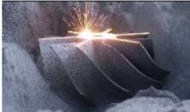
**Figure 1.7: Fusion laser sur lit de poudre**
