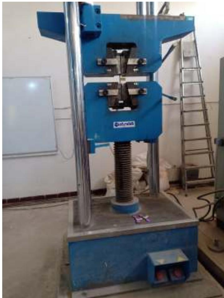
**Figure 3.1: Essai de traction sur la machine Controlab 600KN au laboratoire matériaux de construction**
