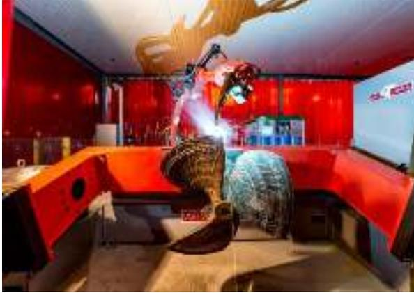
Figure 1.18: le RAMLAB poursuit la fabrication additive d'une hélice de bateau
