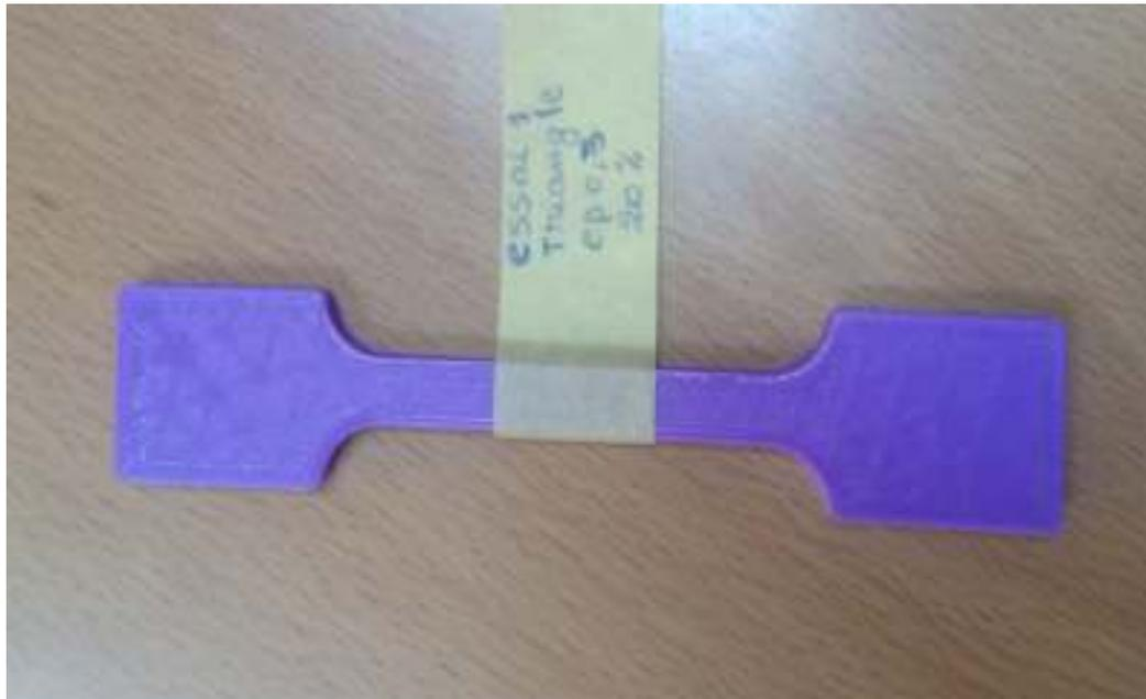
Figure 3.5: Eprouvette réelle imprimé en 3D
