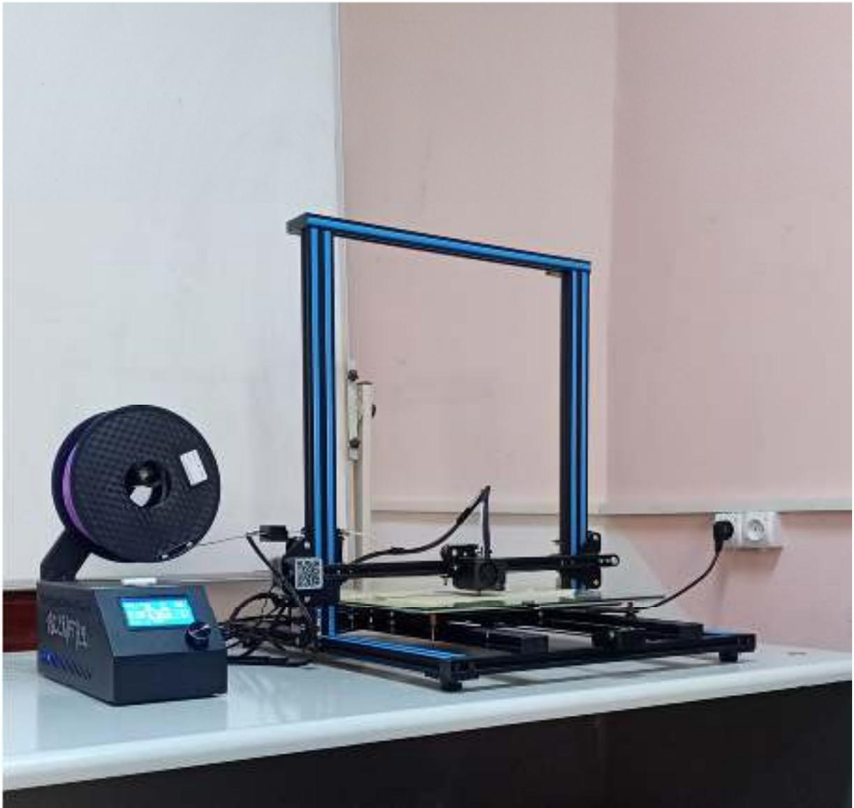
**Figure 2.1: imprimante 3D Creality CR-10 S4 au laboratoire MECACOMP**
