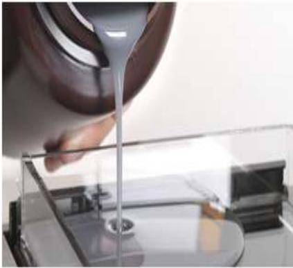
**Figure 1.10: La technologie SLA utilise un matériau sous forme de résine**
