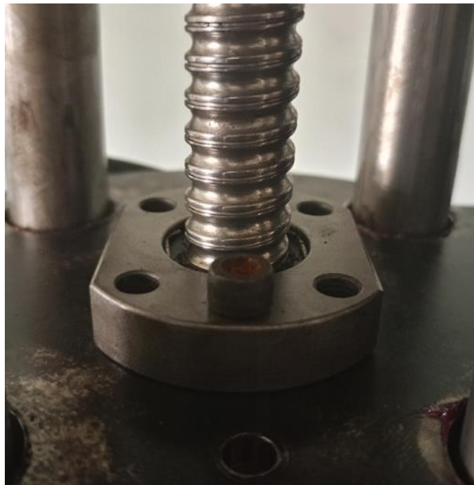
Figure 86 : correction du montage de vis à bill
