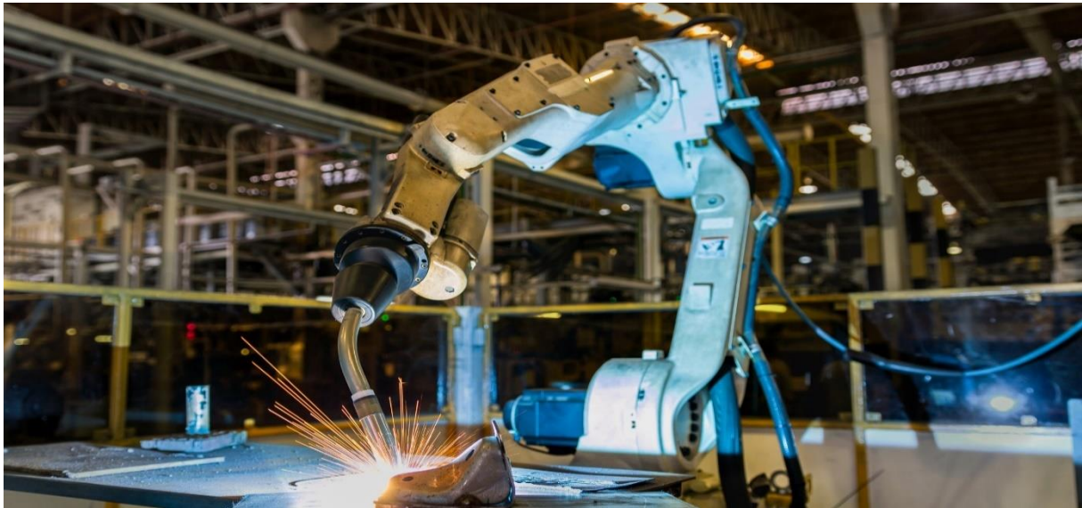
Figure 38: opération de soudage par un effecteur de soudage [70]
