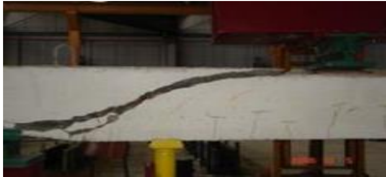
Figure I-8 : Rupture par effort tranchant [20].
