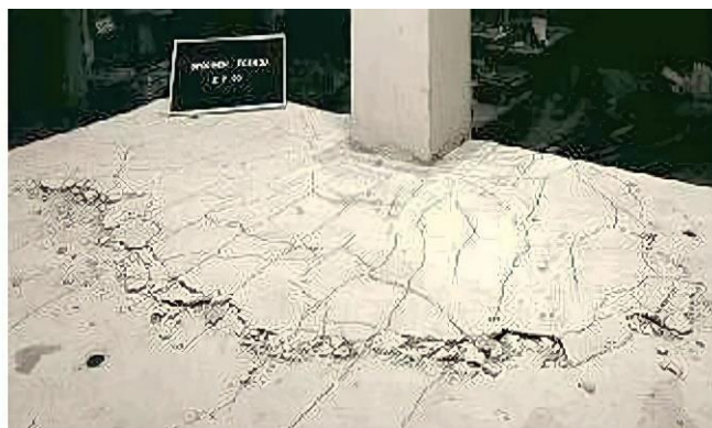
Figure I-7 : Des efforts concentrés, comme près des colonnes, peuvent provoquer une rupture de la dalle par poinçonnement [19].
