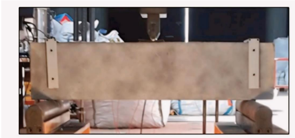
Figure III-2 : Système d'essai de flexion en trois points [25].
