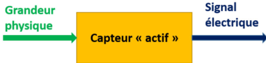
Figure II. 3 : schéma représentatif d'un capteur actif
