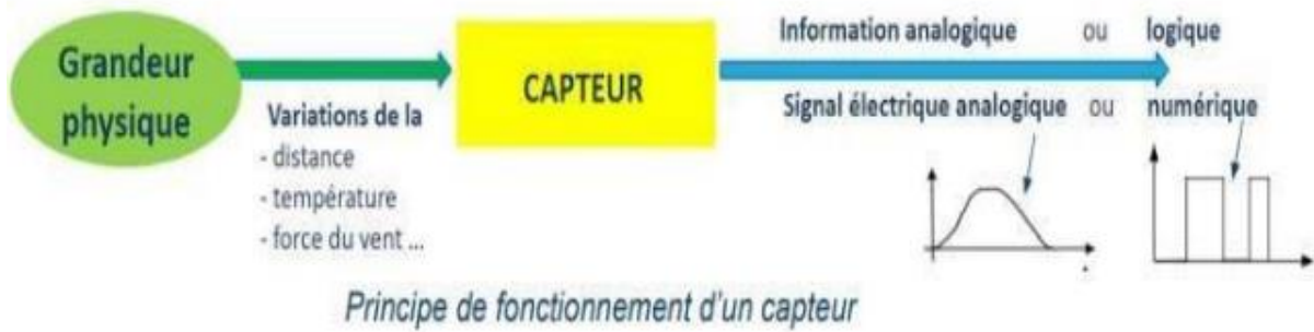
Figure II. 1 : Principe d'un capteur [1].
