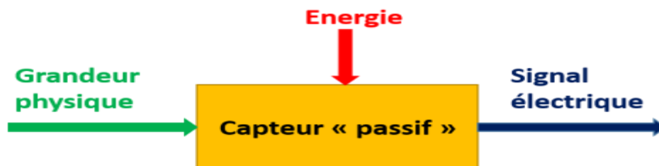
Figure II. 2 : schéma représentatif d'un capteur passif
