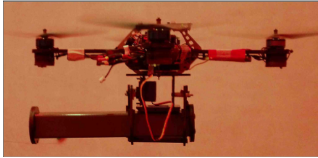
FIGURE 1.5 – Drone avec pince ventrale pour la saisie et le transport d’objets [22]
