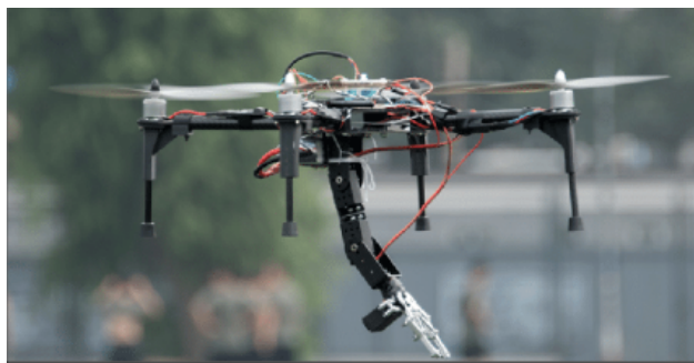
FIGURE 1.6 – Drone muni d’un bras manipulateur sériel à 2 DDL
