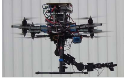
FIGURE 1.1 – Quadricoptère avec manipulateur à 7 articulations (AMUS octoquad) [9]
