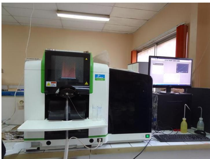
**Figure II.3:** Spectrométrie d'absorption atomique (Perkin Elmer / PinAAcle 900H).
