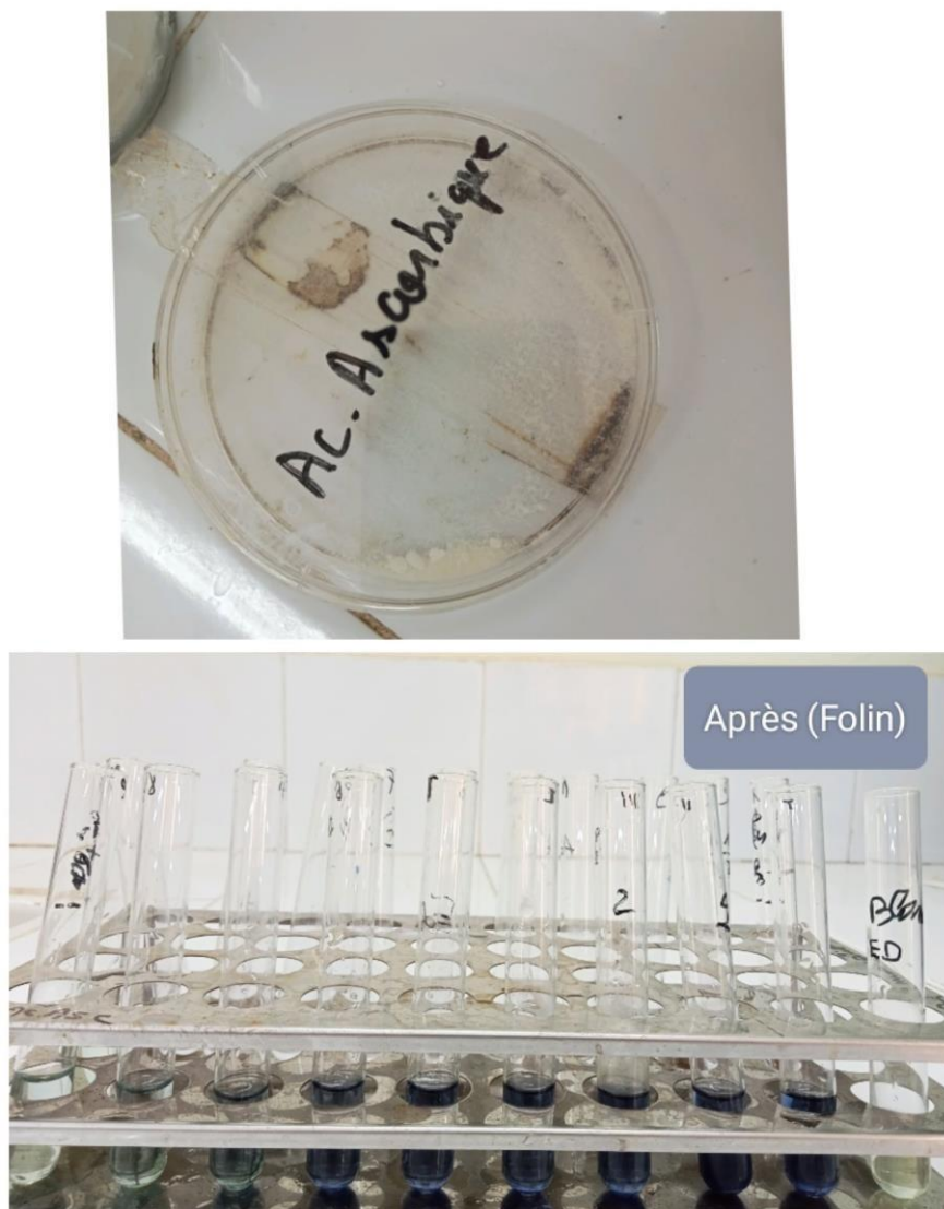
Figure 29: Gamme d'étalonnage pour doser l'acide ascorbique (vit C) (photo original).
