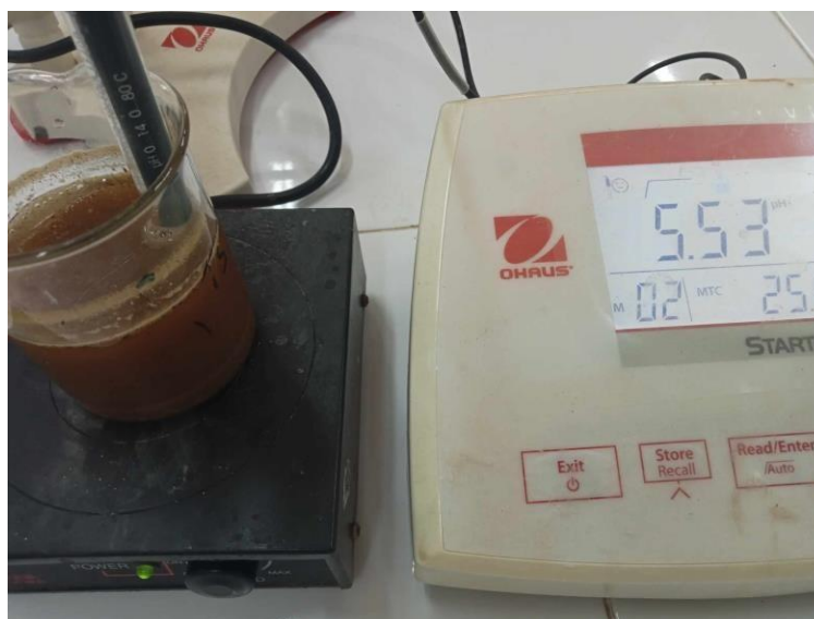
Figure 18: Mesure de potentiel d'hydrogène de la poudre de réglisse (photo original).
