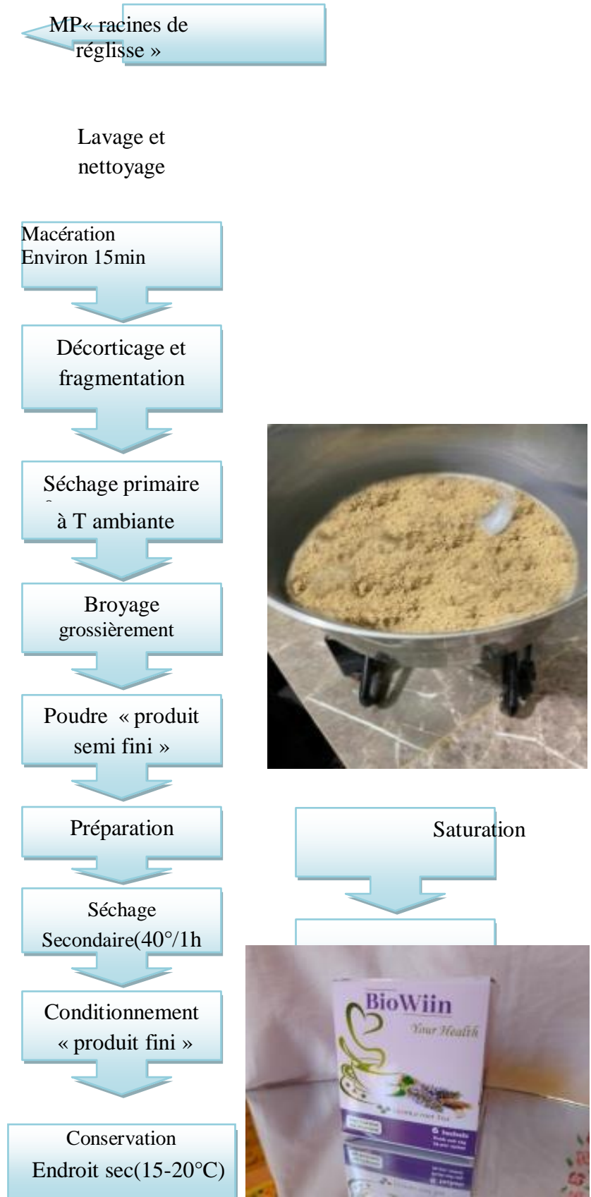
Figure 14: Diagramme de fabrication de tisane de réglisse (site N°6).
