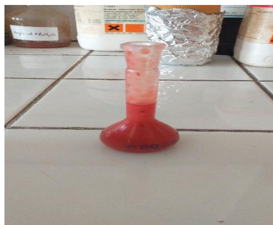
Figure 13 : Photo de la fiole remplie de 20 mL de smoothie utilisée pour déterminer sa masse volumique.
