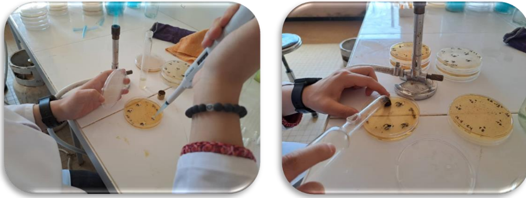
Figure 21: méthode des puits (Photo personnelle, 2024)
