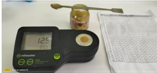
**Figure 11 : La détermination du Brix (originale, 2024)**
