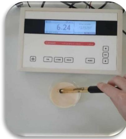
Figure 15: Détermination du pH.
