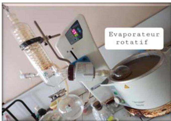
**Photo 06** : L'évaporateur rotatif utilisé dans l'étape d'évaporation (photo prise par nous-mêmes).
