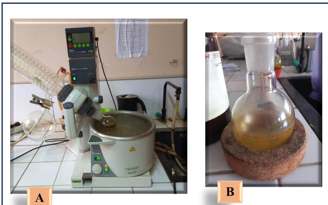
**Photo 09 : A : Évaporateur rotatif, B : Extrait sec de T24 h obtenue après évaporation du solvant (photos prises par nous-mêmes).**
