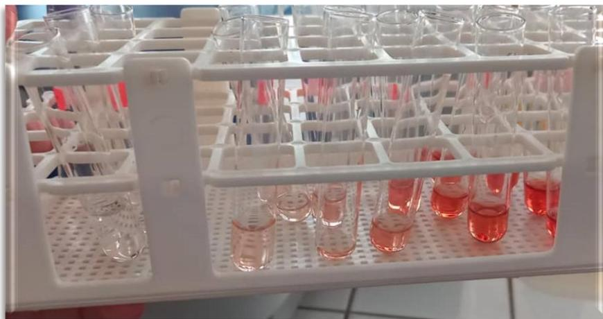
**Photo 18 :** La gamme d'étalonnage de la catéchine.
