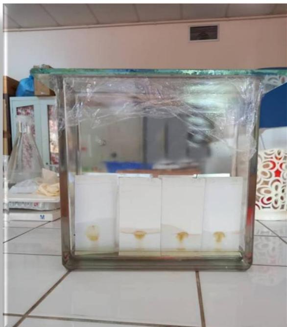
**Photo 10 :** Processus de développement des plaques CCM dans la cuve chromatographique
