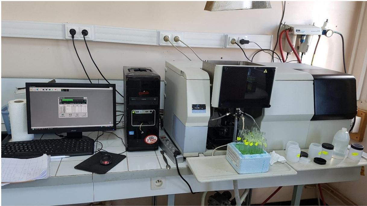
**Figure 19** : Appareil de spectrométrie atomique de Marque : PERKIN ELMER INSTRUMER ANALYST 300
