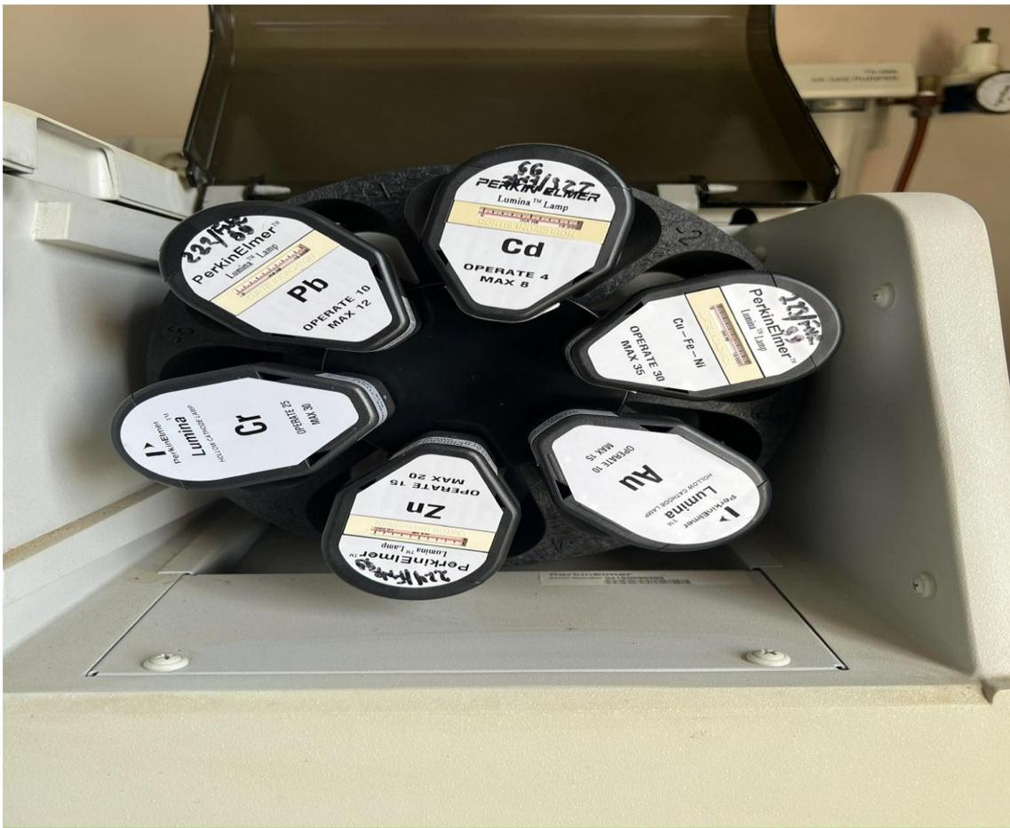
**Figure 20** : Lampe de type HCL pour le Cr, Zn, Cd, Pb, et le A
