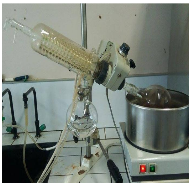
Figure06 : Evaporation de l'extrait eau-acétone par le rotavapeur
