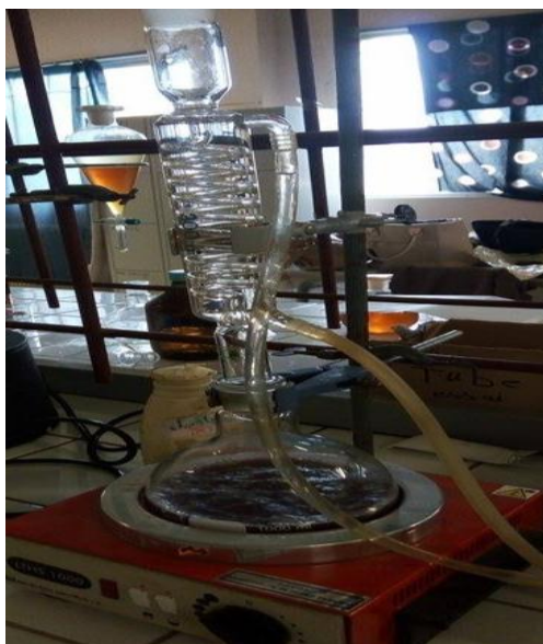
Figure05 : Montage de la décoction sous le reflux.
